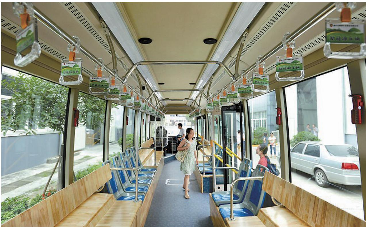
8月19日,记者在成都经开区腹地找到了成都联腾动力控制技术有限公司,看见了新型纯电动公交车样板车。这个“隐身”于成都汽车制造基地,正在和川汽紧密合作,预备年底推出成都版的“特斯拉”。在这辆电动公交车里,大部分座椅沿车体两侧侧向排列,中间走道比普通公交车宽约一个身位。该车还自带车载充电机,完全充电需3小时,续航200公里,30分钟即可充电80%。
