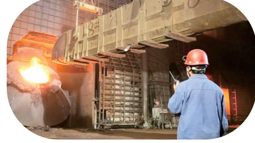
在生产现场,炉前工、摇炉工、维修工等各个岗位之间配合默契。加废钢时,行车工精准地将废钢倒入转炉;兑铁水时,炉前工与铁水运输人员密切沟通,确保铁水顺利注入。出钢时,各个岗位更是全神贯注,严格按照流程操作,每一个环节都衔接紧密,有条不紊。
