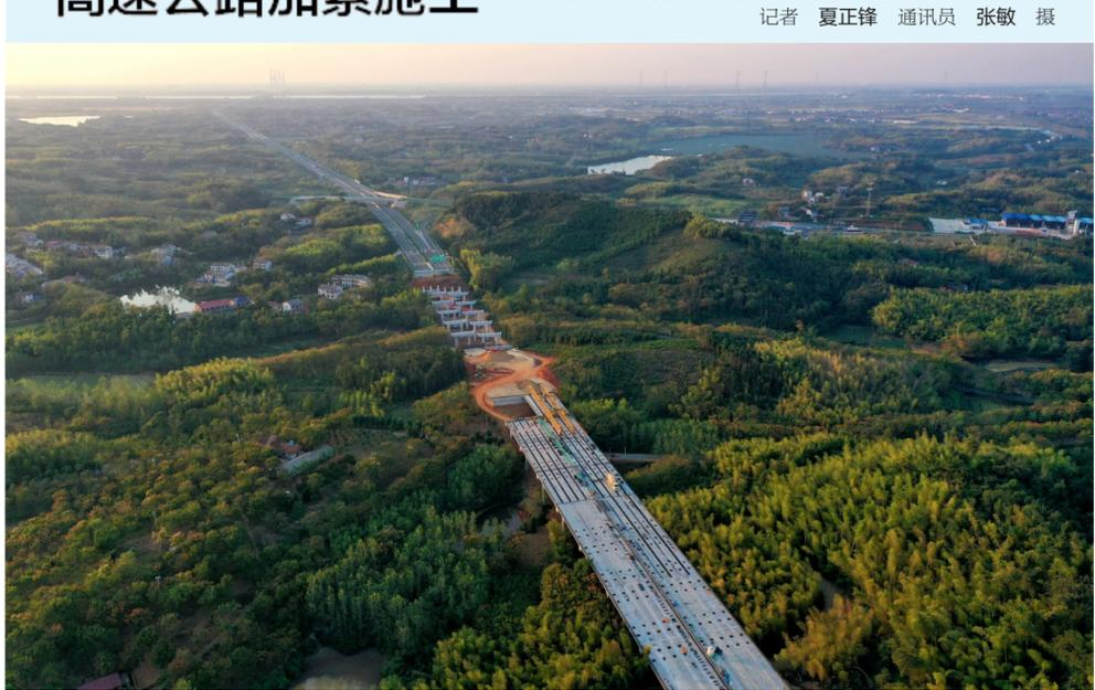
10月10日,无人机镜头下的赤壁长江公路大桥东延段高速公路初具雏形。该项目起于赤壁长江公路大桥南岸,止于赤壁市蒲圻街道舒家湾附近,设陈屋枢纽互通与京港澳高速公路相接,目前正在施工路面基层、下基层和上基层施工。
