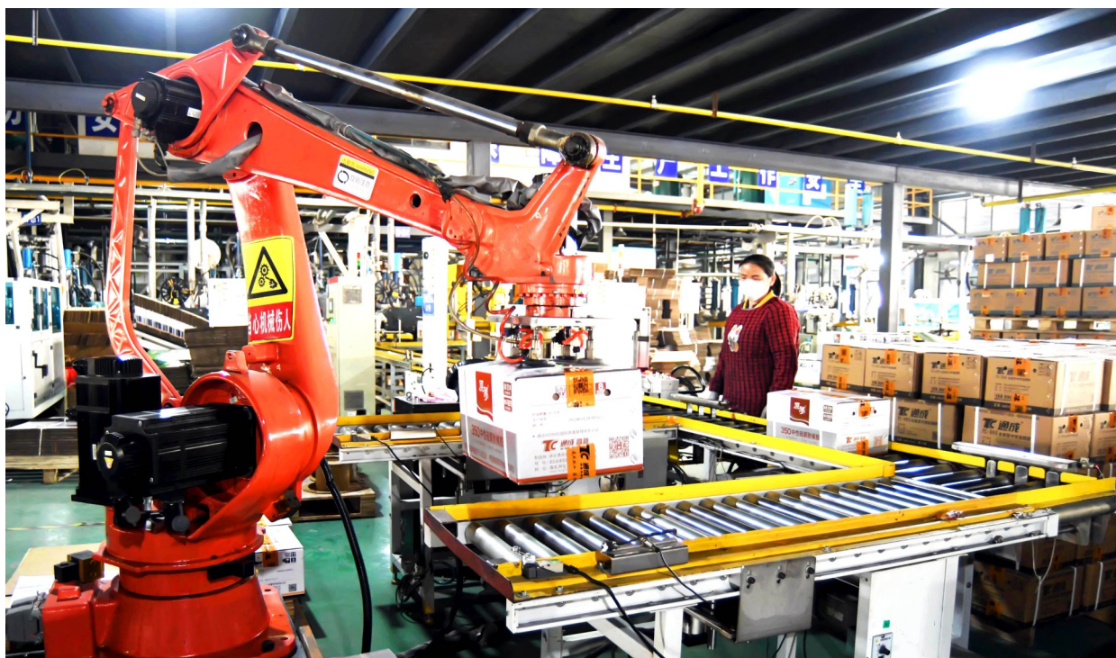
3月12日,通城县经济开发区,湖北通成新材料有限公司生产车间,机械臂自动化分拣传输带上的货物。
