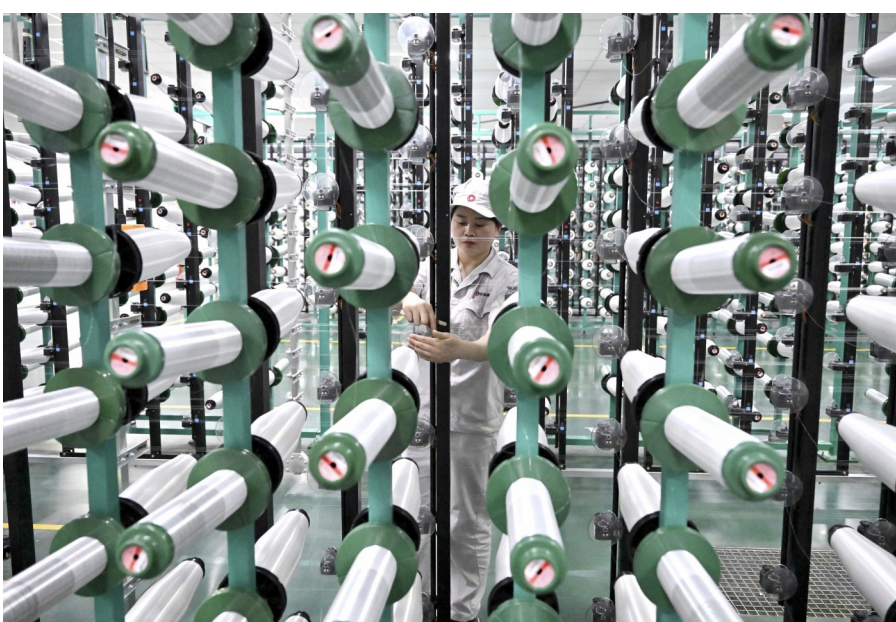
3月13日,在位于河南安阳林州市的河南光远新材料股份有限公司自主技术制备车间,工作人员在检查整经机台。该公司通过自主研发攻克“卡脖子”技术,研发出口“低介电电子纱”(C)用超薄电子布等产品。河南安阳积极承接新兴产业布局,培育引进多家电子信息领域龙头企业,加速形成新型电子显示材料研发生产基地。(据新华社)
