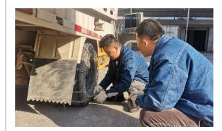
近日,气温降低,通山县烟 草专卖局组织中转站送货员和 驾驶员开展车辆防滑应急演 练,演示车辆遇到湿滑冰雪路 面如何操作、如何装拆防滑链, 详细讲解防滑链安装的要领。 提高驾驶员的安全意识、特殊 操作技能和应对恶劣天气的驾 车能力,全力保障寒冬季节正 常送货。
