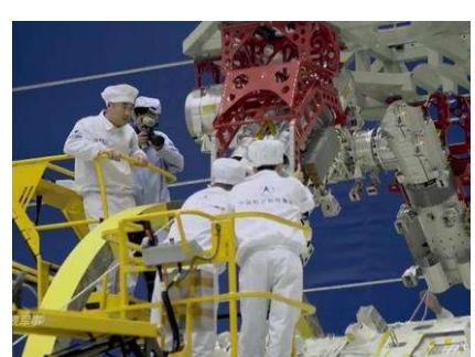
为了攻克技术难关,研究人员需要做大量试验。空间站系统主任设计师张昊介绍说:“这个核心舱一共有300多个传感器,要测量900多路信号,目的就是为了测量这个22吨的一个大家伙,在发射过程当中到底能够承受多大的载荷。”
