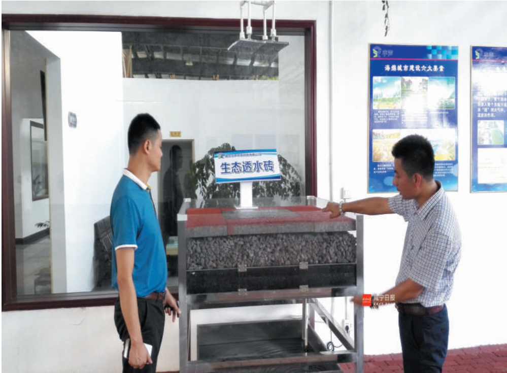
湖北宇声环保科技有限公司总经理杨博(右)在演示生态透水砖的透水功能
