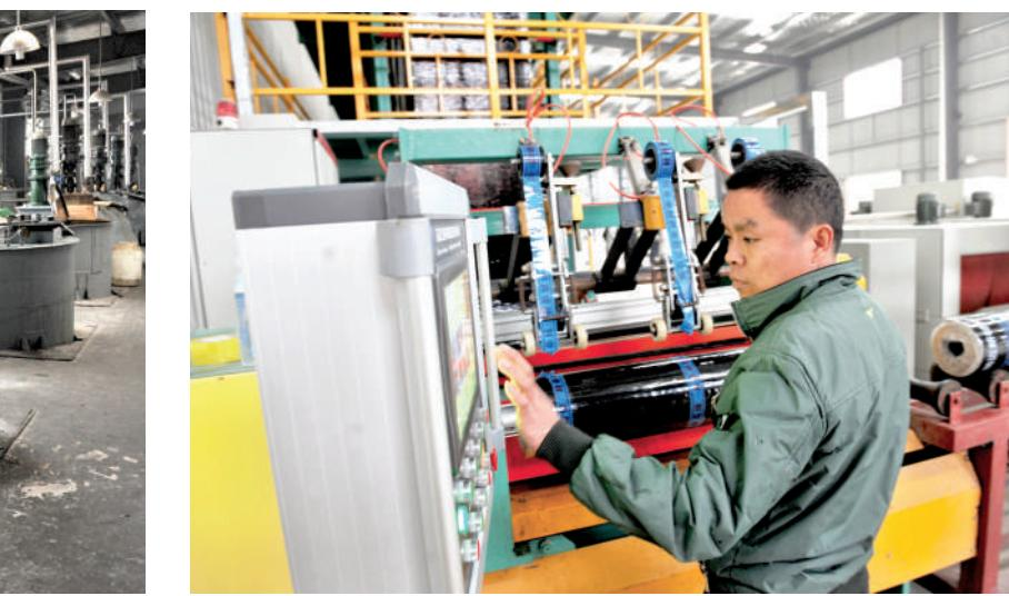
**朗迈新材料:**该项目位于武汉新港潘湾工业园,主要生产防水卷材、防水涂料及防腐、环氧树脂地坪涂料等产品。项目占地50亩,总投资1亿元,拥有功能进口改性沥青防水卷材生产线、自粘沥青防水卷材生产线、高分子卷材生产线和环保防水涂料生产线及试验、检测设备。目前改性沥青防水卷材生产线已建成并试运行,可年产2200万平米防水卷材、30000吨防水涂料、20000吨防腐及环氧树脂地坪涂料。
