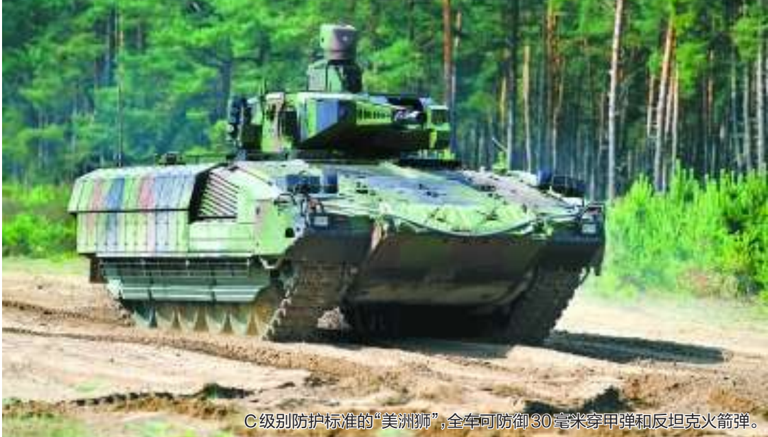
C级别防护标准的“美洲狮”，全车可防御30毫米穿甲弹和反坦克火箭弹。
