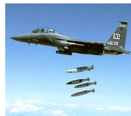
联合制导攻击弹药(JDAM)利用卫星定位系统(GPS)引导的全天候、自动寻地常规炸弹。JDAM是在现役航空炸弹上加装相应制导控制装置而成,就是取下原有炸弹尾翼,装上有全球定位和惯性制导控制的尾部装置,并在弹体中部加装了保证炸弹飞行稳定的翼片,从而构成“联合直接攻击弹药”。
