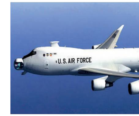
美国国防部和波音公司联合研发的“机载战术激光”系统是由飞机搭载的高能激光武器系统。作为美国导弹防御系统的一部分,它可以从空中对敌方导弹等目标实施精准打击。
