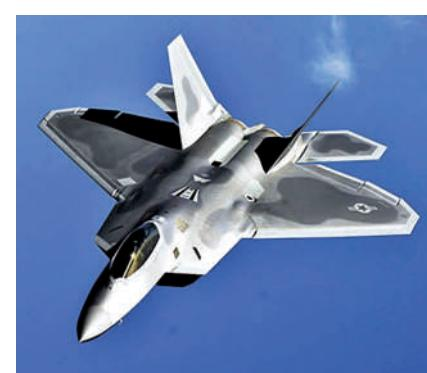
F-22是世界上第一种进入服役的第五代战斗机。它具有多项特色,例如所有操控系统均为数字化。其外形独特,材质可吸收雷达波,导弹、炸弹均装置于舱内,具有隐形效果。
