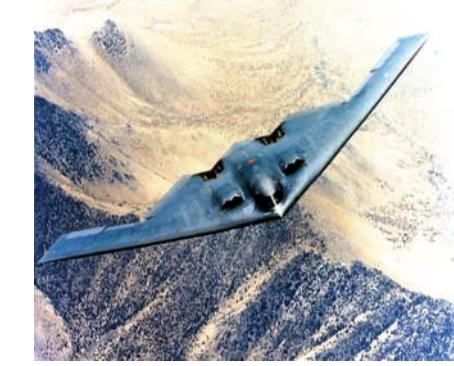
B-2是美国诺斯罗普公司研制的战略突防隐身轰炸机。该机的研制始于1978年,原定是一种高空突防的轰炸机,1983年研制计划修改,使B-2成为一种可进行低空突防的轰炸机。
