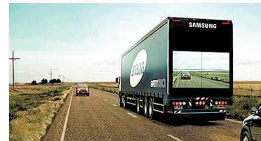
据国外媒体报道,在双向单车道高速公路上开车时,如果刚好前面有辆货运半挂车堵着,在视线被挡的情况下,贸然变道是十分危险的行为。针对这一情况,三星公司计划推出一种全新的技术,可以让货车后面的司机也能看到前方的路况,防止盲目变道。
