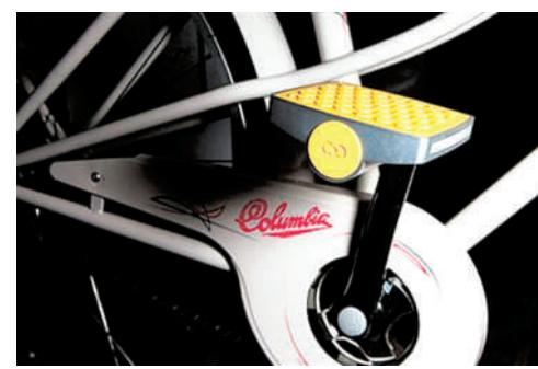
这款踏板中加入了GPS模块和GPRS模块,可以实现跟踪车辆,并将自行车位置发送到手机App中。而且,它不需要供电,可以把用户的运动转化为自身所需的电能,该踏板适用于任何品牌的自行车。为了踏板不会像车锁一样那么容易地被小偷拆掉,每个踏板还会配套一个特殊的转接头和一把钥匙,保证只有车主才能将它拆下。
