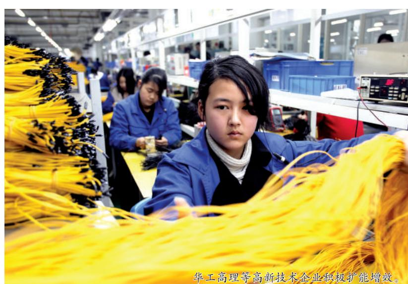
11月26日,华工科技孝感产业园的生产流水线上,工人正将比米粒还小的热敏芯片植入温度传感器——它能像人的皮肤一样,感受温度的细微变化,并转换为精准的数字信息。
