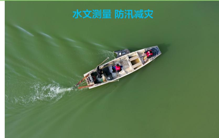
日前,淦河咸宁向阳湖奶牛良种场窑咀段,市水文局技术人员正在测量相关数据。技术人员使用GPS和走航式ADCP采集水位、流量、流速与高程信息,为淦河和斧头湖防汛减灾提供精确的数据支撑。
