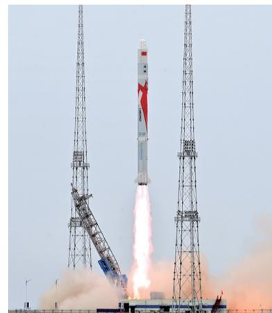
发动机助推朱雀二号运载火箭复飞成功,表明我国初步建立了开式循环液氧甲烷发动机设计、生产、试验体系,培养了相关人才队伍,研制的各型液氧甲烷发动机可逐步满足国内商业发射需求。
