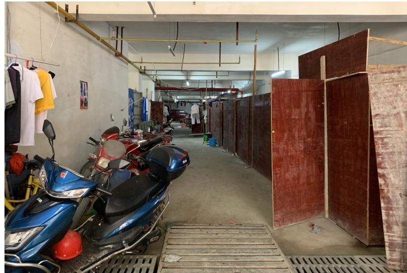
执法中,温泉消防救援大队严厉批评教育了开发商和施工方负责人,明确指出地下车库改成集体宿舍属于“三合一”场所,存在严重火灾隐患,并告知要消除在建施工工地消防安全隐患,严禁违规住人、严禁违章用火用电,确保消防临时用水充足、消防通道畅通。
