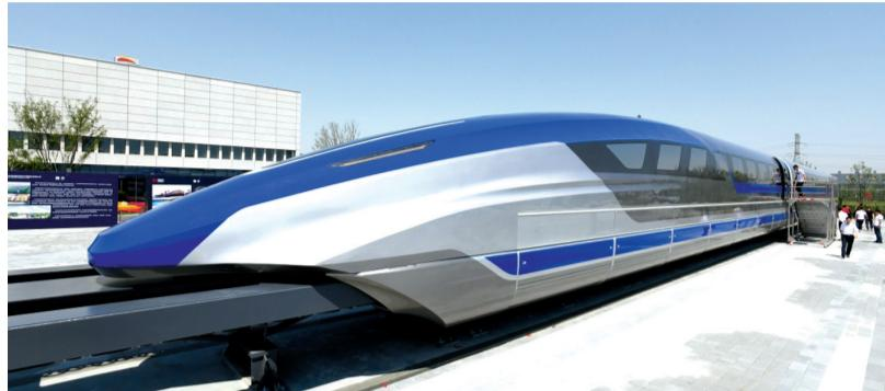
高速磁浮关键技术及核心系统部件进行验证和优化。试验样车的下线,为后续工程化样车的研制打下了技术基础。“目前试验样车实现了静态悬浮,状态良好。”丁叁叁说。
