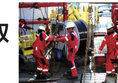
化率等科学数据。为了保证钻孔质量，“决心”号会放弃第一个钻孔(A)，在附近再打第二个钻孔(B)，放入套管和再入锥，用RCB钻头打穿沉积层，从“小山丘”顶部向下钻取岩石样品。
