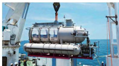
必须要能承受每平方厘米9公斤的要求。同时,按照这样的强度来设计观光潜水器。此外,在检验时,要把壳体压到90米深,所以绝对安全。”
