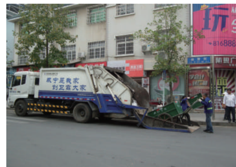
中联ZLJ5160ZYSE3型压缩车正在主干道上收集垃圾
