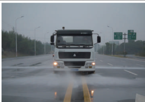
中联ZLJ5251GQXE3型洒水车正在作业
