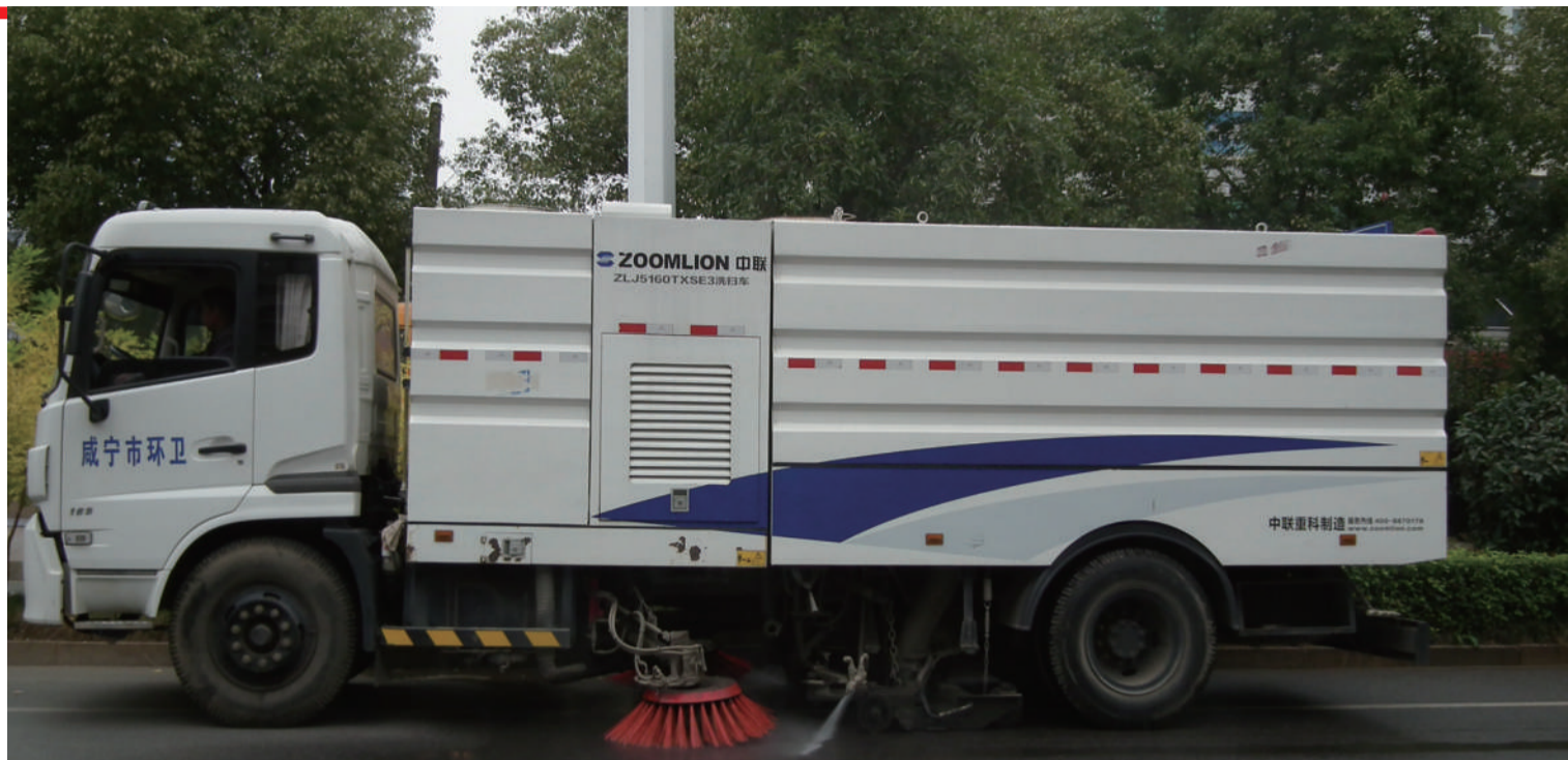
中联ZLJ5160TXSE3型洗扫车正在作业
