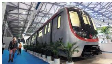
**新华网消息** 6月17日,中国首列无人驾驶地铁列车在上海2014中国国际轨道交通展亮相。据悉,这辆无人驾驶地铁列车为3节编组,最大载客约1500人,外观与普通地铁相似,不设驾驶室。这种新型车将无需司机和乘务人员介入,可实现列车自动唤醒、自动发车离站、上下坡行驶、到站精准停车、自动开关车门等操作。
