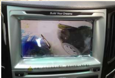
车尾和右后视镜的摄像头提供倒车参考
